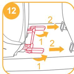
3. Совместите фиксаторы Isosafe с анкерными креплениями ISOFIX и вставьте оба фиксатора Isosafe в точки анкерного крепления ISOFIX до щелчка. <sup>13</sup>
