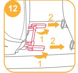
3. Isosafe bağlayıcılarını ISOFIX tutturma noktalarıyla hizalayıp, her iki Isosafe bağlayıcıyı ISOFIX tutturma noktalarına takın. 13
