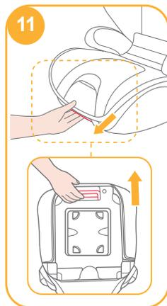
Поверните крепления Isosafe на 180 градусов и затем нажмите кнопку регулировки Isosafe. Пока они не будут направлены в направлении направляющих ISOFIX. <sup>12</sup>
