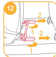
3. Dopasuj złącza Isosafe do punktów kotwiących ISOFIX, a następnie zatrzaśnij obydwa złącza Isosafe w punktach kotwiących ISOFIX. **13**
