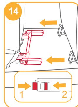
В. Поверните крепления Isosafe на 180 градусов и затем нажмите кнопку регулировки Isosafe, чтобы убрать крепления Isosafe. <sup>15</sup>
