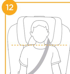
2. Поднимите рычаг для регулировки подголовника и при этом потяните подголовник вверх или вниз так, чтобы он защелкнулся в одном из 7 положений. Положения подголовника показаны на рис. 13.
