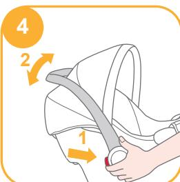
Для регулировки положения рукоятки нажмите на кнопки по обеим ее сторонам, чтобы разблокировать рукоятку ④ -1, а затем поверните рукоятку, чтобы она зафиксировалась со щелчком в любом из 3-х положений. ④ -2
