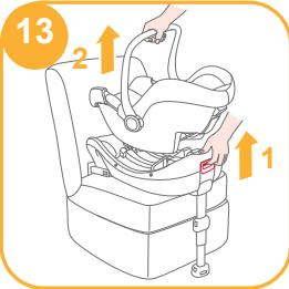
8. Чтобы снять основание, сначала нажмите вторую кнопку фиксатора 14 -1 , а затем кнопку креплений ISOFIX 14 -2 и снимите основание с автомобильного сиденья. 14
