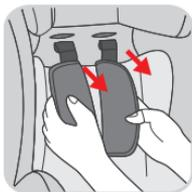
Repliez maintenant la partie d'assise (ST) et guidez le verrou de sécurité inférieur (SB) latéralement dans les trous de la base.
