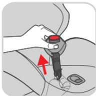
Le dispositif ISOFIX n'est homologué en G II et G III qu'en tant que fixation supplémentaire. Vous pouvez fixer le siège avec ISOFIX (I) pour éviter que le siège ne glisse. Veuillez suivre les étapes de la section 1.3.
