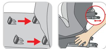
Vérifiez les indicateurs de sécurité. Ces deux éléments doivent être ROUGE. Si les indicateurs de sécurité (ROUGE) ne sont pas visibles, appuyez sur les boutons de déverrouillage jusqu'à ce que vous entendiez un >>clac<<.
