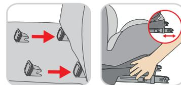
Les points de fixation ISOFIX sont situés entre le siège et le dossier du siège auto.
