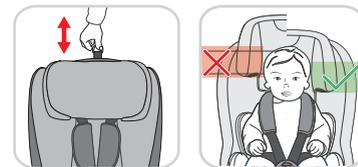
L'appui-tête doit être réglé de manière à ce que la distance entre les épaules de l'enfant et l'appui-tête ne dépasse pas environ 3 cm (environ 2 doigts de largeur).
