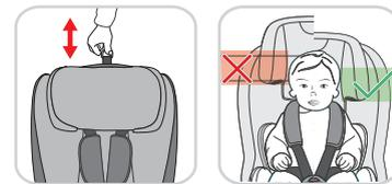
Регулировка системы ремней для ребенка производится при помощи перестановки высоты подголовника (А).
