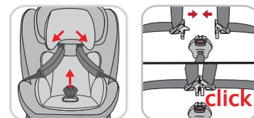
Joignez les deux languettes de verrouillage (C) des sangles de harnais (G2) ensemble et connectez-les avec la boucle (D) jusqu'à ce qu'un « clic » clair se fasse entendre.
