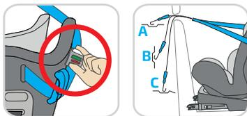
Attachez la ceinture au dos du siège avec les **DEUX** guides de ceinture marqués en bleu.
