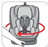
Чтобы привести в действие функцию вращения, необходимо нажать на кнопку фиксации и одновременно повернуть сиденье в нужное направление. Сиденье фиксируется отчетливым щелчком.
