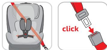
Passez la sangle diagonale de la ceinture de sécurité 3 points dans les guides de ceinture bleus à l'arrière du siège auto jusqu'à la boucle.
