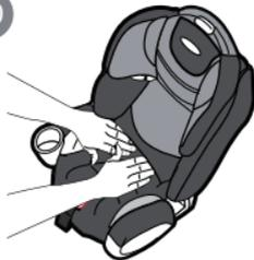
50 Подоткните подкладку сиденья в зазор между спинкой и сиденьем автокресла, чтобы показались 2 эластичных петли на задней части сиденья.
