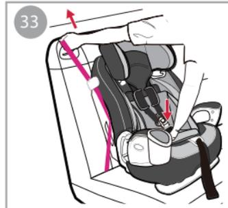
**33** Затяните ремень безопасности автомобиля. Плотно прижмите детское автокресло по центру коленом или свободной рукой. Затем потяните и затяните ремень безопасности автомобиля.
