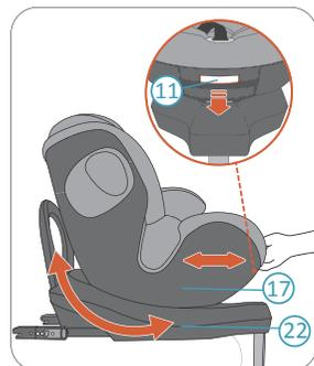
AVOVA Sperber-Fix i-Size имеет 3 положения наклона в направлении вперед и 3 положения наклона в направлении назад. Для регулирования положения наклона, нажмите Кнопку регулирования наклона (11) и подвиньте Корпус детского кресла (17) нажимая и двигая его вперед к корпусу детского кресла (22).
