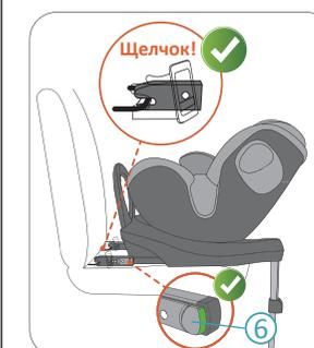
**4.** Нажмите на одно из креплений ISOFIX для соединения с точкой крепления ISOFIX с характерным звуком до щелчка. Повторите действие для другого крепления для соединения обоих креплений ISOFIX.
