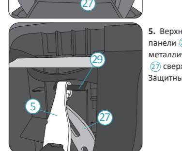
5. Верхнее Кольцо Якорного Ремня **3** на панели **29**. Соедините и застегните металлическое соединительное кольцо **27** сверху Якорного Ремня **3**. Застегните Защитный Чехол Спинки **18**.
