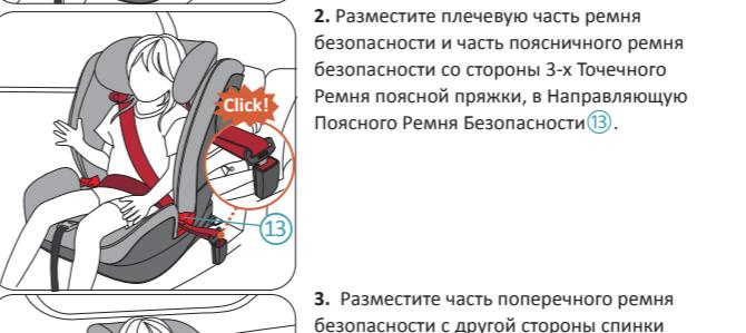
2. Разместите плечевую часть ремня безопасности и часть поясничного ремня безопасности со стороны 3-х Точечного Ремня поясной пряжки, в Направляющую Поясного Ремня Безопасности **13**.
