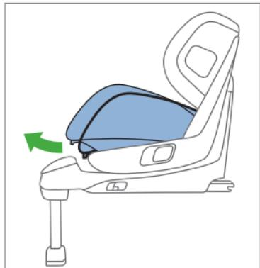
如果達到了想要的位置，可以鬆開並扣緊座椅位置調整控點 (15)。通過在座椅托架上按拉的動作來檢查是否牢固扣緊。
