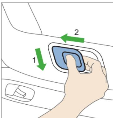
為了解鎖旋轉功能，請首先將旋轉功能解鎖手柄 (13) 中間的按鈕向下按，然後將解鎖手柄 (13) 向外拉動。現在可以向側面旋轉座位。
