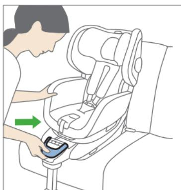
向上提起 ISOFIX 長度調整控點 (14) 手柄，並將 RECARO ZERO.1 推往車內座椅的方向，直到兒童座椅椅背平整地緊貼在汽車座椅椅背。
