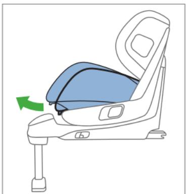
Как только кресло установлено в необходимое положение, отпустите рычаг регулировки положения кресла (15) и зафиксируйте кресло. Проверьте надежность фиксации, нажав или потянув чашу кресла.
