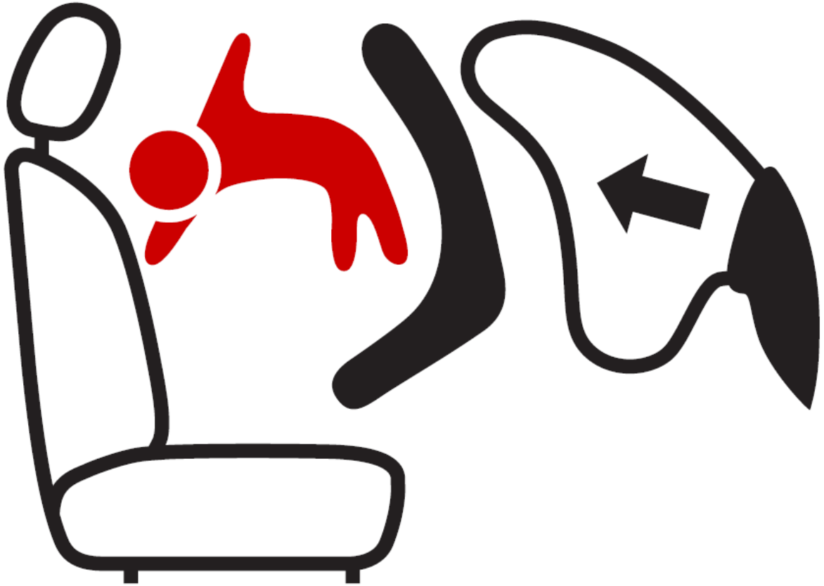
Рис. С Пиктограмма, указывающая на опасность срабатывания используемой подушки безопасности, размеры которой должны составлять 40 мм по ширине и 28 мм по высоте или пропорционально превышать эти значения
