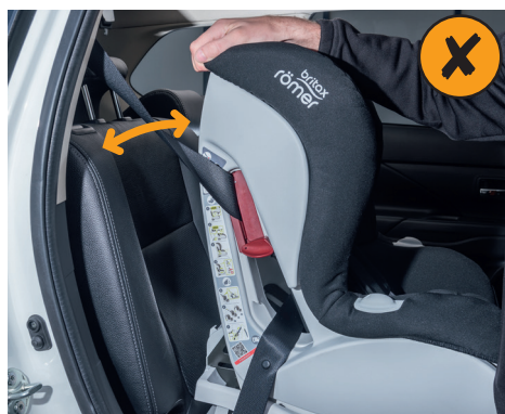
FALSCH: Zu lockerer Sitzeinbau; Kindersitz wackelt und kann bei einem Unfall nicht optimal schützen.
