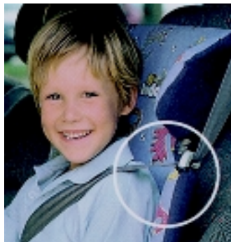
Beispiel für eine optimale Gurtführung am Hals
