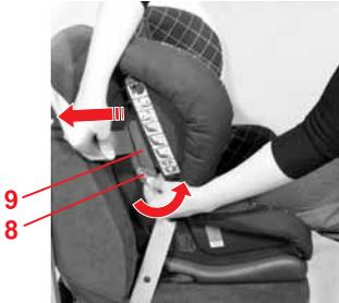
✘ Теперь повернуть вниз зажимный рычаг 8 со стороны, расположенной напротив замка ремня автомобиля, и вставить диагональный ремень в зажим ремня 9.
