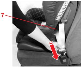
✘ Зафиксировать язычок замка в защелке замка ремня.
