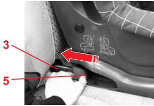
Отжать зеленую фиксирующую головку **5** от себя с другой стороны и зафиксировать стопорный рычаг **3** защелкой ("щелчком").
