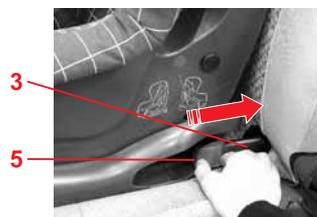
✎ Отжать зеленую фиксирующую головку 5 от себя с другой стороны и зафиксировать стопорный рычаг 3 защелкой ("щелчком").
