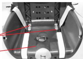
✎ Вытащите металлический элемент **37**, с помощью которого ремень снизу крепится к **11** сиденью.
