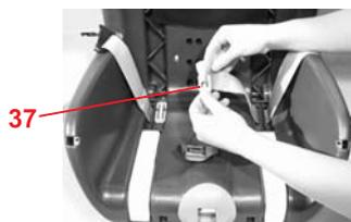
✎ Отодвиньте петлю ремня на короткой стороне металлического элемента **37** и отцепите его.
