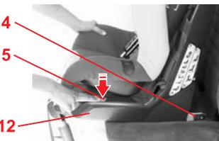
✎ Вставьте оба консольных фиксатора **4** в приемные приспособления **1**, чтобы фиксаторы зашли в зацепление с **обоих сторон**. "ЩЕЛК!" **Внимание!** С обеих сторон на кнопках предохранения **5** теперь должны стать заметны зеленые маркировки **7**.
