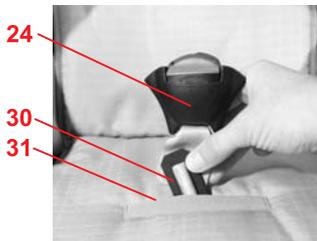
пластинку **30**, при помощи которой замок ремня **24** закреплен на сиденье, ребром через паз для ремня **31**.
