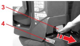
✎ На зеленой рукоятке **3** тяните оба консольных фиксатора до тех пор **4**, пока они не зафиксируются.
