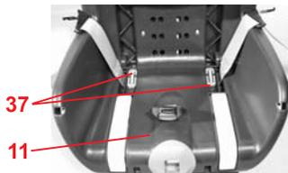
✎ Вытащите металлический элемент **37**, с помощью которого ремень снизу крепится к **11** сиденью.
