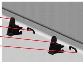
\* Приемные приспособления облегчают встраивание детского сиденья при помощи ISOFIX и предохраняют чехол сиденья от повреждений. При отказе от использования они должны быть сняты и сохранены в надежном месте. В автомобилях с откидывающейся спинкой перед откидыванием спинки следует снять приемные приспособления.
