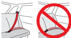
**⚠ Опасно!** Если ребенок фиксируется в детском сиденье только ремнем безопасности с двухточечным креплением, то в случае дорожно-транспортного происшествия он может получить тяжелые травмы или даже погибнуть.
