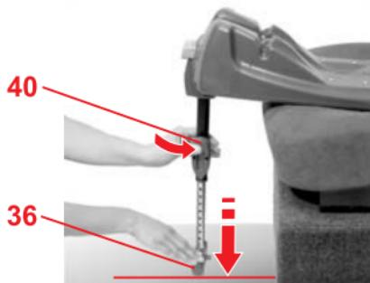
⇨ Нажмите на кнопку регулировки **40** и вытяните опору **36** так, чтобы она надежно стояла на полу автомобиля.
