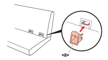
• Вытащите фиксатор упора и снимите блокировку. Разложите упор <17>. Задвиньте фиксатор, заблокировав упор в открытом положении. Чтобы обеспечить себя достаточным пространством для выполнения вышеописанных действий, положите детское кресло на бок. Установите кресло на сиденье автомобиля. Используя кнопки по бокам, выдвиньте упор так, чтобы он касался пола. Щелчок означает что положение зафиксировалось. Ориентируйтесь на показатель индикатора поддержки <18>:
