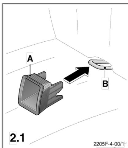
Путём нажатия зелёных кнопок можно вынуть разъёмные «изофикс»-элементы. Это является необходимым перед каждой новой установкой в другой автомобиль. Вставьте разъёмные «изофикс»-элементы (А) платформы в вводные вспомогательные элементы.
