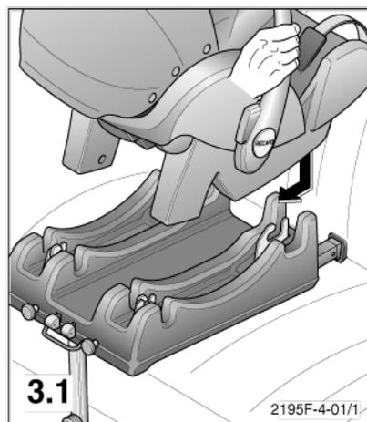
Ввести сиденье в паз переднего закрепления. Проверьте ввод сиденья в паз впереди и сзади путём приподнятия его.
