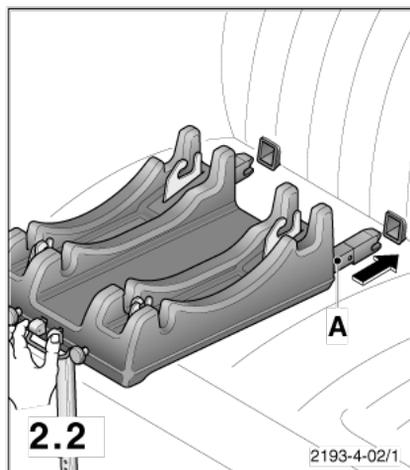
Введите в паз «изофикс»-ручек разъёмные «изофикс»-элементы. Красная маркировка на кнопках деблокировки должна быть не видна! Проверьте ввод в паз подтягиванием на обеих сторонах платформы.
