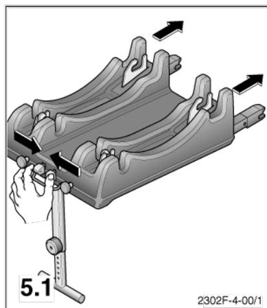
Разъедините разъёмные «изофикс»-элементы путём подтягивания обеих кнопок деблокировки.
