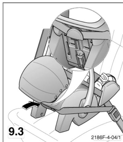
Угол установки сиденья в автомобиль должен быть такой, чтобы индикация находилась в зелёной зоне (Topline).
