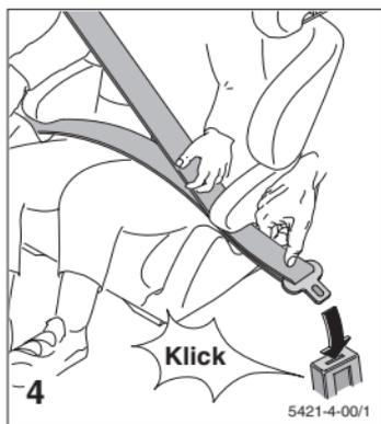
Вставьте поясной ремень трехточечного ремня безопасности в направляющие ремня и закройте замок. Замок должен закрыться с хорошо слышимым щелчком.
