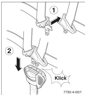
Закройте замок, соединив оба язычка (1) и вставив их в замок со слышимым щелчком (2).
