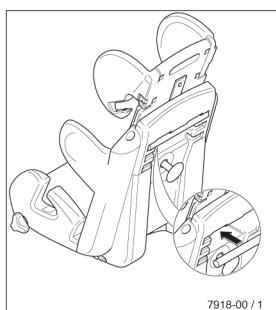
Установите подголовник во 2-е положение снизу и протяните ремни крепления блока плечевой подушки сквозь прорези назад. Вставьте, как показано на рисунке обводную трубку и протяните ремни крепления поверх трубы.
