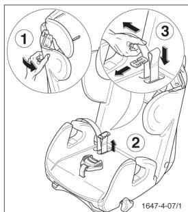
Чтобы снять плечевую подушку надо снять чехол подголовника и протолкнуть плечевую подушку через прорези для ремней. После этого можно убрать модуль плечевой подушки.
