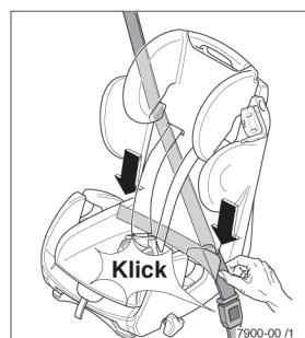
Зашелкните замок ремня и вставьте поясной ремень трехточечного ремня безопасности в задние направляющие, пропустив его через красные натяжители ремня безопасности.
