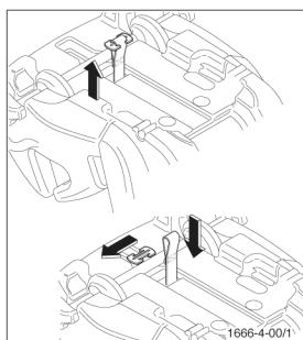
Высуньте металлическую пластину из пахового ремня, а затем вытяните ремень за замок по направлению от поверхности сиденья.
