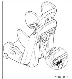
Переставьте подголовник в самое верхнее положение и ослабьте винт с грибковой ручкой. Передвиньте обводную трубку немного вниз и снимите ремни крепления плечевой подушки. Затем снимите обводную трубку.
