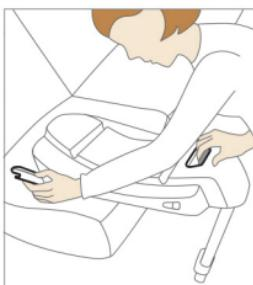
Для выдвижения фиксаторов Isofix нажмите ручку в центре платформы RECARO fix и вытяните фиксаторы до упора.
