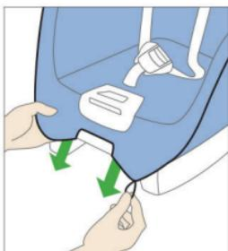
Чтобы снять чехол нижней части кресла, необходимо взяться рукой под передним краем чаши кресла и отсоединить крепежные петли. Это будет легче сделать, если Вы предварительно сдвинете чащу кресла в самое переднее положение.
