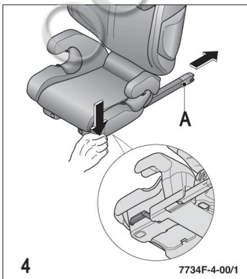
Для установки автокресла необходимо выдвинуть коннекторы Seatfix (A). Для этого нажмите на запорные рычаги, расположенные по бокам сиденья автокресла, и вытяните коннекторы Seatfix назад до упора.
