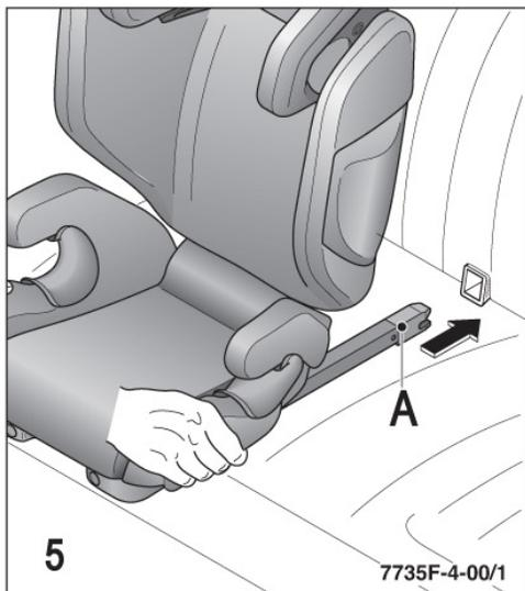
Наденьте коннекторы Seatfix (A) на скобы крепления Isofix, при этом на обоих коннекторах должна быть видна зеленая маркировка. Проверьте надежность фиксации, потянув с двух сторон за поверхность сиденья.
