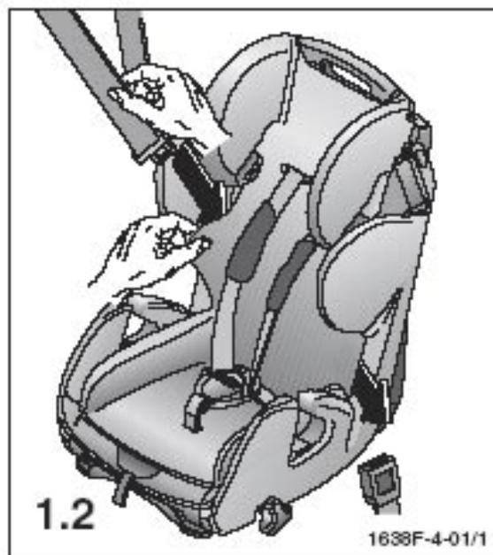
Закройте замок ремня до отчетливого щелчка и вложите нижний ремень трехточечного ремня безопасности в задние направляющие.
