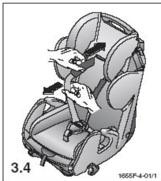
Удалите болт и вытяните поворотную трубку вниз. Снимите плечевые ремни.
