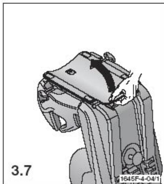
Освободите металлическую пластину из ремня ступенчатого натяжения и вытяните замок вверх.
