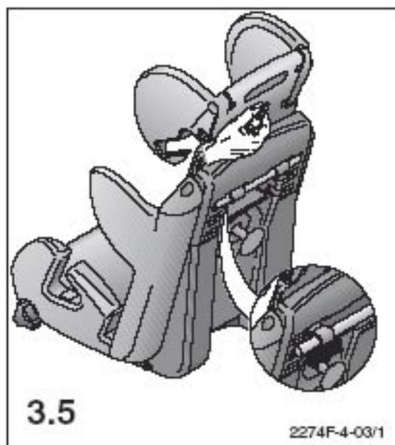
По частям снимите чехол сиденья и вытяните нижние ремни из корпуса поддона.
