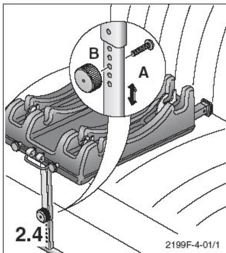
2.4 Настройка опорной ножки: Удалить гайку и вытянуть болт. Определить отверстие так, чтобы опорная ножка стояла на полу. Вновь вставить болт и крепить его при помощи гайки
