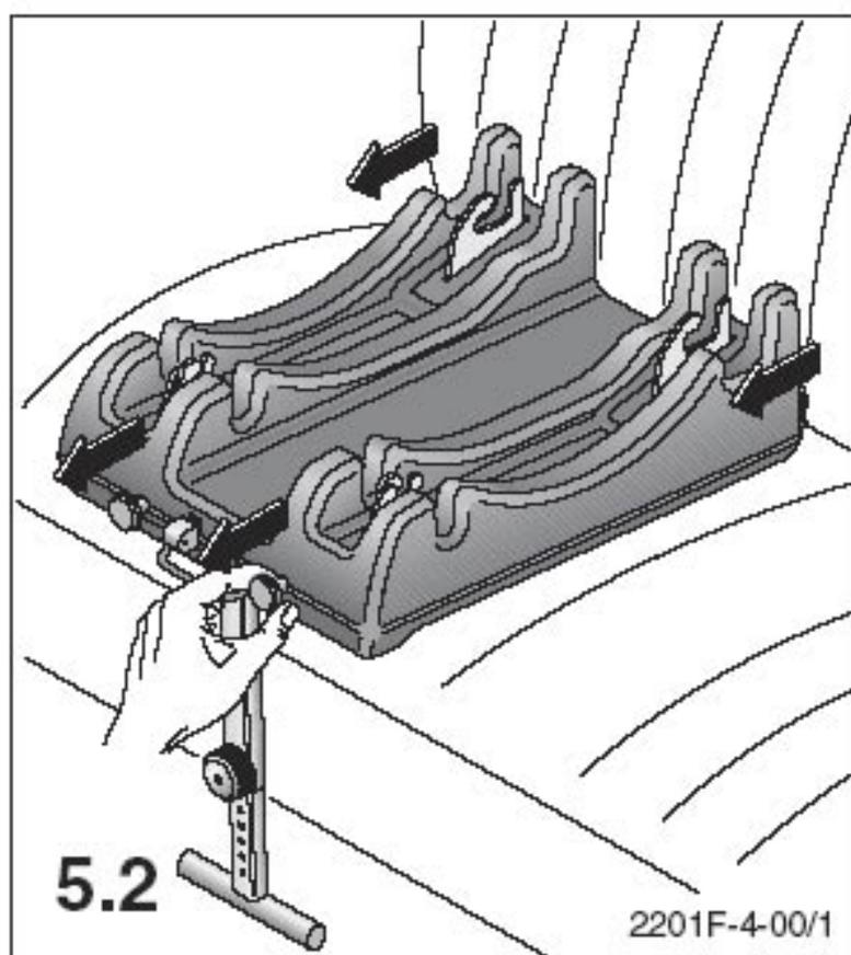
5.2 Разъедините разъёмные «изофикс»-элементы путём подтягивания обеих кнопок деблокировки.
