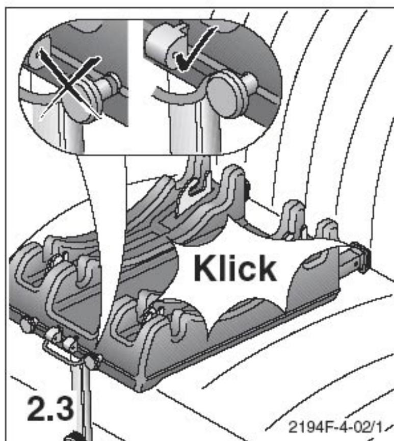
2.3. Введите в паз «изофикс»-ручек разъемные «изофикс»-элементы. Красная маркировка на кнопках деблокировки должна быть не видна! Проверьте ввод в паз подтягиванием на обеих сторон платформы.
