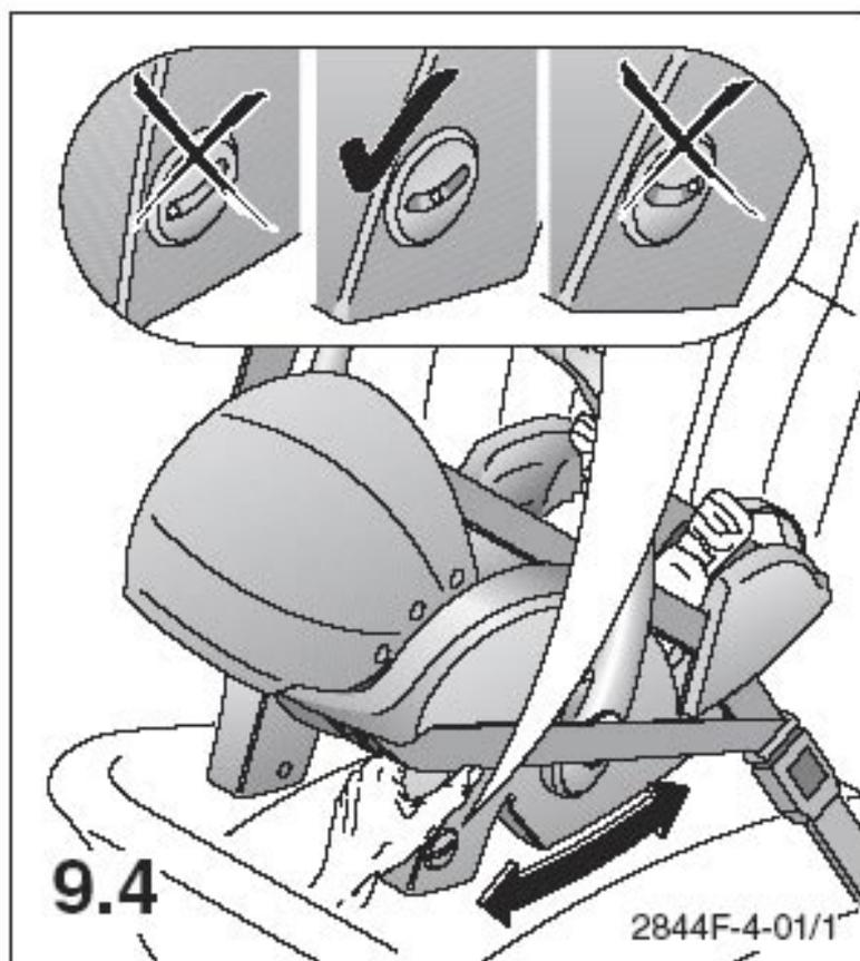
9.4 Угол установки сиденья в автомобиль должен быть такой, чтобы индикация находилась в зелёной зоне (Topline).
