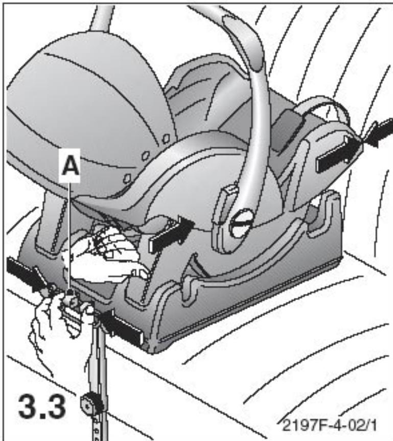
3.3 Нажать обе зелёные кнопки (А) для деблокировки первой фиксации в пазах. Потом можно, без нажатия зелёных кнопок, сдвинуть систему назад как можно ближе к автомобильной обшивке.
