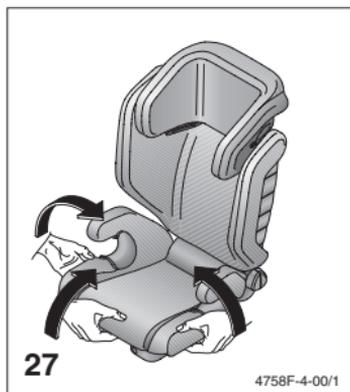
Нижние пластиковые планки извлеките из соответствующих прорезей. Снимите чехол снаружи, начиная с направляющих ремня. Сами направляющие при этом демонтировать нельзя.
