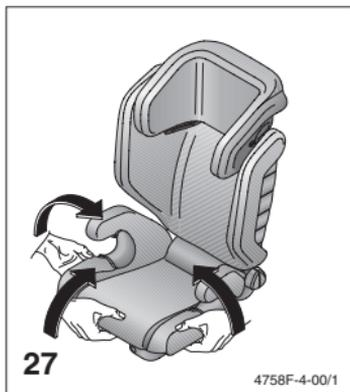
Retire las molduras de plástico inferiores de las respectivas hendiduras. Comenzando por la parte de fuera, pase la funda por las guías del cinturón. Estas no se deben desmontar para ello.
