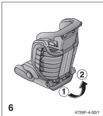
Para activar la posición de reposo, gire el estribo desde la posición 1 hacia la posición 2. Para ello es necesario tirar el asiento un poco hacia adelante en el vehículo. Al usar los conectores Seatfix, también los mismos tienen que ser retirados un poco.
