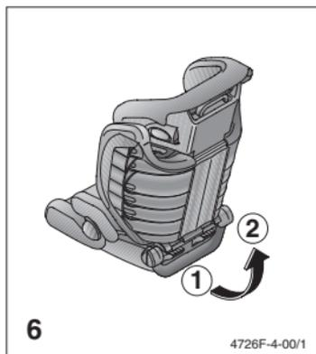
Для перевода сидения в откинутое назад положение переведите ручку из положения 1 в положение 2. Для этого сидение в автомобиле необходимо передвинуть немного вперед. При использовании соединителей Seatfix их также нужно выдвигать дальше.
