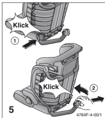
Montaje del estribo para la posición de reposo: Introduzca el mismo desde un lado en el eje de giro dispuesto en la pieza de respaldo (1). A continuación dóblelo un poquito lateralmente y encaje la clavija opuesta en el otro lado del eje (2).
