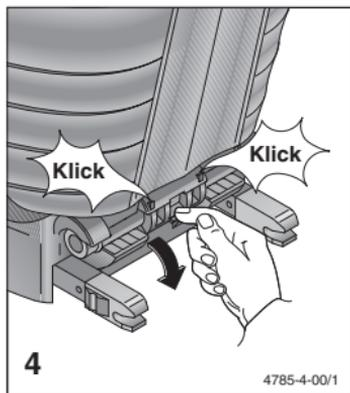
Поверните фиксатор спинки в задней части сидения вниз до тех пор, пока оба фиксирующих выступа не войдут в зацепление с характерным щелчком.
