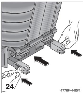
Desmontaje del Seatfix:
