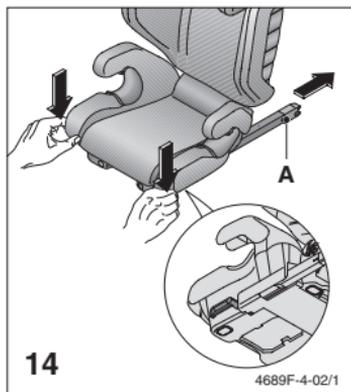
Para el montaje en su vehículo hace falta retirar los conectores Seatfix (A). Esto funciona con la palanca de retención en el lado inferior apretada.
