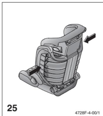
Боковые ребра жесткости повышают уровень защиты Вашего ребенка при боковом столкновении и обеспечивают комфортную заднюю вентиляцию всей спинки сидения.
