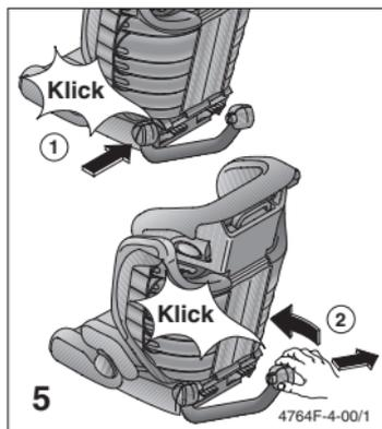
Установка ручки для перевода в откинутое положение: Вставьте ручку сбоку в поворотную ось, расположенную в задней части сидения (1). После этого отведите ручку немного вбок, а затем наденьте расположенную с противоположной стороны цапфу на другую сторону оси (2).
