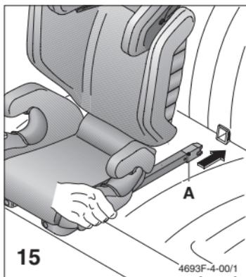
Haga engatillar los conectores Seatfix (A) en los estribos Isofix; al hacerlo, tiene que aparecer la marcación verde en el conector. Verifique el engatillamiento tirando de ambos lados en la superficie de asiento. Ud. consigue una seguridad aún mejor mediante un ajuste en posición vertical.
