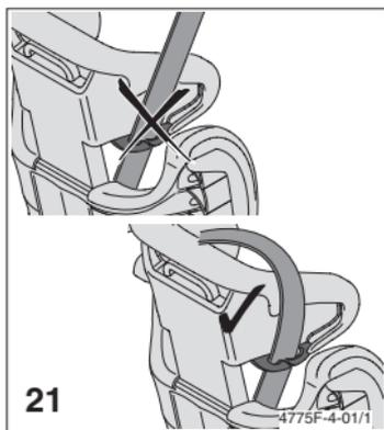
A ese respecto, el cinturón debe conducir solamente hacia atrás. Caso necesario, utilizar el asiento solamente en el asiento trasero.
