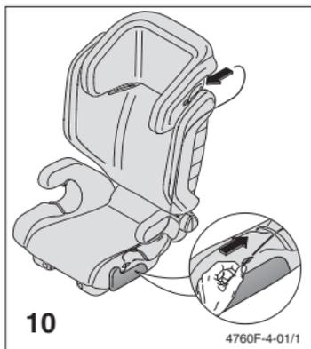
La línea de conexión al sistema sonoro puede ser colocada en forma cómoda por debajo del acolchado. El orificio previsto para ello se encuentra al lado del bolsillo para su equipo de casetes.
