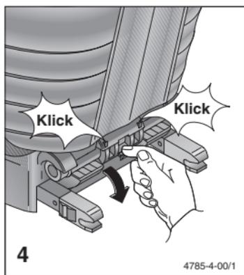
Gire el dispositivo de seguridad del respaldo dispuesto en el lado posterior del asiento hacia abajo hasta que los dos pernos de retención engatillen con un "clic" audible.
