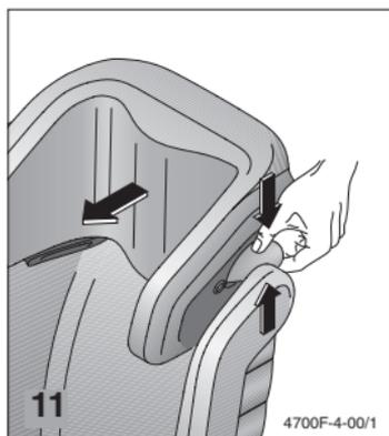
Теперь установите регулируемую воздушную подушку в стандартное «полное» положение для обеспечения оптимальной безопасности (15-20 нажатий).
