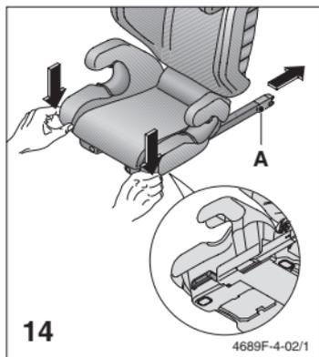
Для установки в Вашем автомобиле необходимо извлечь соединители системы Seatfix (A). Чтобы сделать это, следует нажать на фиксаторный рычаг, расположенный снизу.
