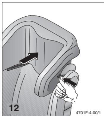
Нажатием спускового клапана в любое время можно активировать положение, в котором голову можно откинуть назад. Легким нажатием на мягкую обивку можно ускорить процесс спуска подушки.
