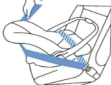
**Рисунок 1:** Поместите люльку на сидение против движения и переведите ручку в положение для транспортировки в автомобиле (См рисунок 1).
