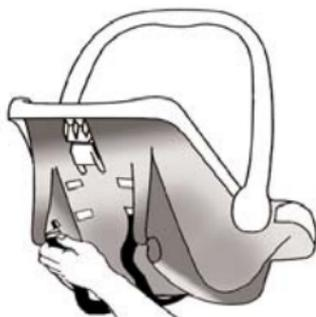
Эта модель имеет 2 положения регулировки ремней по высоте.
