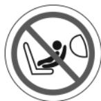
反向儿童安全带拉回系统绝对不允许被安装在配套主动式正面气囊的座椅位置上！
