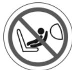
\* Çocuk emniyet sistemi gidiş yönünün tersine bakacak şekilde yerleştirildiğinde, ön yolcu hava yastığının devre dışı bırakılması veya diğer bir koltuğa yerleştirilmesi gereklidir.
