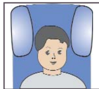
неправильно, слишком высоко
