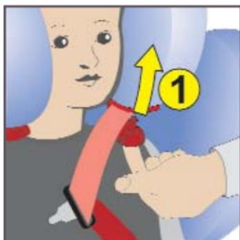
Теперь закройте направляющую, вдавив ее вверх в фиксатор (поз. 1).
