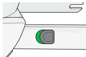
Удерживая кнопку TWINFIX (09) в вытянутом положении, подвиньте сиденье CONCORD TRANSFORMER, как можно плотнее, к спинке сиденья автомобиля. После того как детское сиденье установлено в требуемое положение, отпустите кнопку TWINFIX (09).
