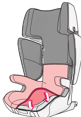
При установке обшивки следует начинать с нижней части сиденья.
