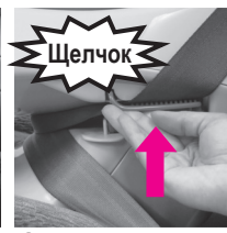
3 Нажмите на стопор ремня полностью до щелчка для надлежащей фиксации.
