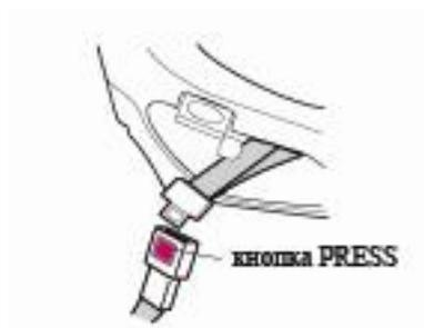
2. Поднимите вверх боковой рычаг и вытащите ремень безопасности из-под фиксатора.
