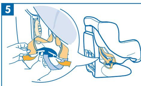
5 – снять пластину фиксации плечевых ремней и отсоединить плечевые ремни.
