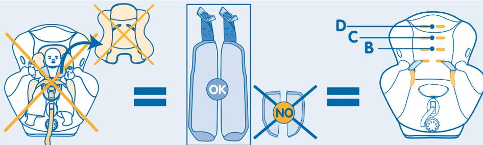
Устанавливать длинные защитные подушки только в положениях (B), (C) и (D).
