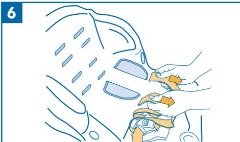
6 – вытянуть ремни в передней части кресла, чтобы вынуть их из защитных подушек. Установить кресло в сидячее положение.
