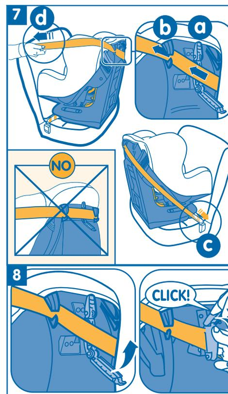
7 - пропустить диагональную часть автомобильного ремня безопасности за спинкой детского кресла, продеть ее через петли (a) и (b), затем с силой потянуть ремень безопасности в точках (c) и (d), чтобы убедиться в надежности крепления.
