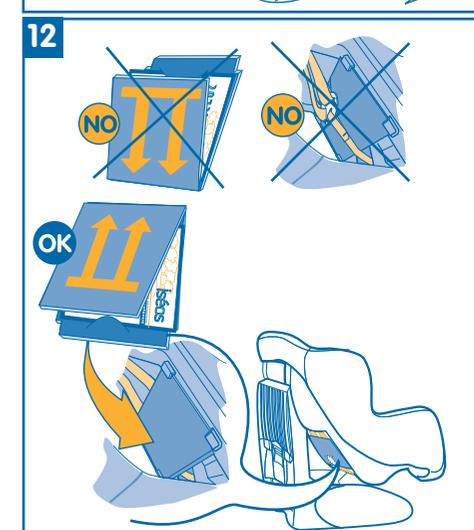
12 – установить пластиковый карман для инструкции на место над крепежной пластиной плечевых ремней (место перегиба должно находиться сверху). Перед использованием убедиться, что ремень правильно функционирует.
