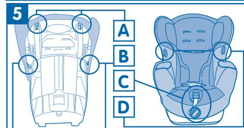
5 – Kilifi çıkartmak için. Esnek halkalar A ve B'yi kancalardan çıkartın, sonra C ve D'deki kilifi gevşetin.
