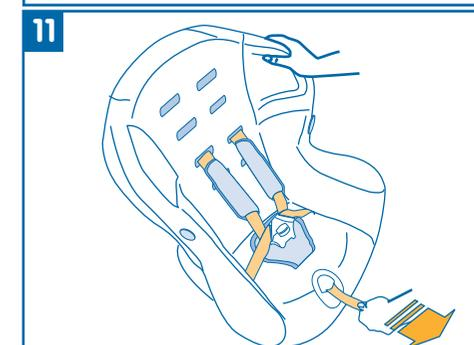
11 – плотно затянуть ремни, вытянув регулировочную стропу.
