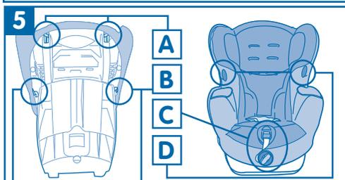
5 – снять чехол. Отстегнуть эластичные петли в точках А и В, затем снять чехол в точках С и D.
