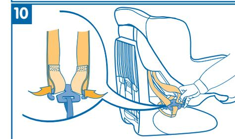
10 – закрепить петли ремней на металлической пластине.
