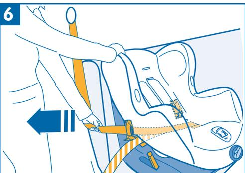
6 – потянуть за диагональную часть ремня безопасности, чтобы убедиться в надежности крепления (пряжка оснащена невозвратным механизмом для крепления ремня).
